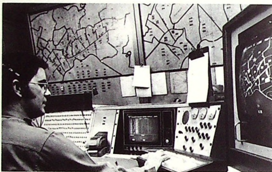
Die Anlage in der Kommandozentrale umfaßt einen Kleincomputer, einen Bildschirm (rechts) zur Anzeige des Wagenstandorts auf Lagekarten sowie ein Terminal mit Tastatur und Bildschirm (Mitte)
